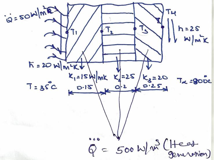
$$[K_T^1] = \frac{15A}{0.15} \begin{bmatrix} 1 & -1 \\ -1 & 1 \end{bmatrix} + \begin{bmatrix} 20A & 0 \\ 0 & 0 \end{bmatrix} = 100A \begin{bmatrix} 1.2 & -1 \\ -1 & 1 \end{bmatrix} \begin{matrix} T_1 \\ T_2 \end{matrix} \quad \ddot{Q} = 500 \text{ W/m}^3 \quad (11)$$
