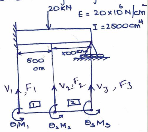
$$4 \times 10^4 \begin{bmatrix} 24 & 0 & 30 \\ 0 & 200 & 50 \\ 30 & 50 & 100 \end{bmatrix} \begin{bmatrix} v_2 \\ \theta_2 \\ \theta_3 \end{bmatrix} = \begin{bmatrix} -20 \times 10^3 \\ 0 \\ 0 \end{bmatrix}$$
